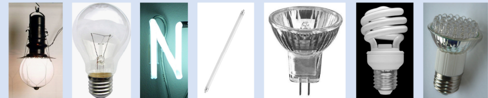
booglamp elektrische spanning tussen twee koolstofstaven gloeilamp stroom door draad wolfram in zuurstofarme glazen bol / laag rendement: 5% licht, 95% warmte neonlamp gasontlading door elektrische spanning doet neon of ander edelgas licht stralen tl-buislamp gasontlading zorgt voor ultraviolette stralen die een fluorescerende laag doen oplichten halogeenlamp gloeilamp met gas onder hoge druk - het halogeen brengt het verdampte wolfram terug op de draad en verlengt zo de levensduur spaarlamp opgevoenen tl-lamp, die in gewone fitting past led-lamp verzameling lichtuitstralende diodes, dat zijn halfeleidercomponenten
